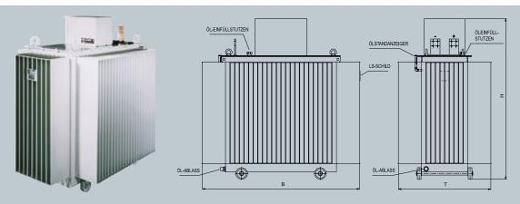
Die Hauptkomponenten sind in einem Stahlblechwellenkessel eingebaut. Auf Grund der hohen Schutzart (IP 54) kann das Gerät direkt in aggressiver Umgebung aufgestellt werden. Die Verlustwärme wird über die Wellenoberfläche an die Umgebung abgegeben.
