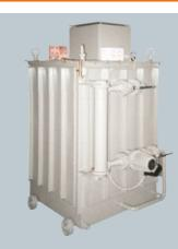
In dieser Bauart können große Leistungen kompakter integriert werden. Der Glattblechkessel dient zur Aufnahme aller Leistungskomponenten und führt einen geringen Anteil der Verlustwärme ab. Mittels Wärmetauscher und Umlaufpumpe wird der Hauptanteil der Abwärme an den Kühlkreislauf abgegeben.
