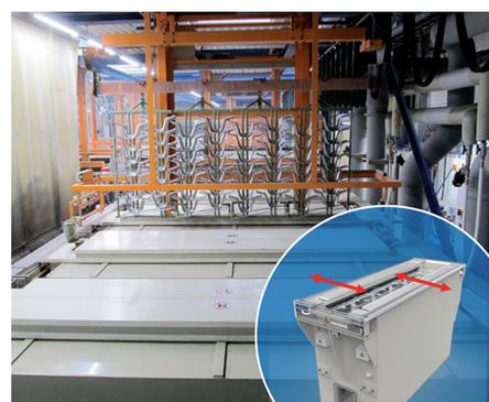
**Ein wichtiges Element der Kondensationstrocknung von Harter für Galvanikanlagen ist das automatische Deckelsystem, mit dem die Luft im Kreislauf gehalten werden kann (Bild: Harter)**
