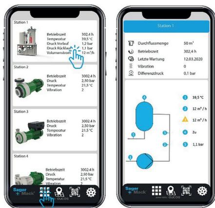
**Die Daten von Pump-Filter-Systemen sind bei der Nutzung von SmartMack auf üblichen Mobilgeräten abrufbar (Bild: Sager + Mack)**
